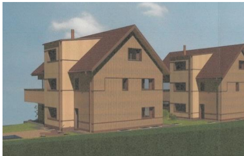
Abbildung 2 Der Vorbau steht 1,15 m vor der Trauflinie und macht das Dachgeschoss zum Vollgeschoss.
