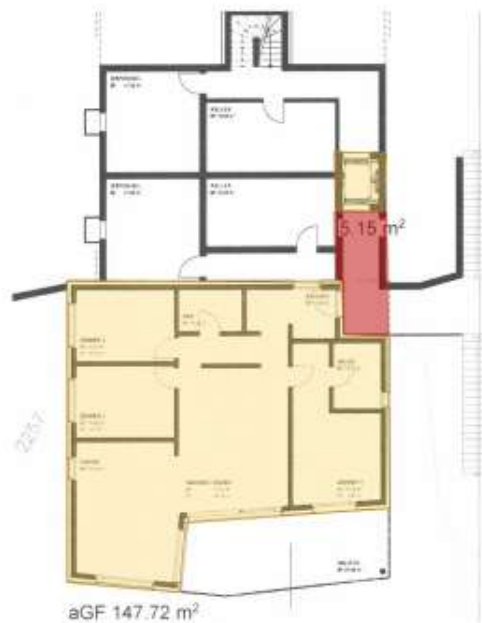
Abbildung 2 1. Obergeschoss: Korridor zum Lift (rot) ist AZ-pflichtig
